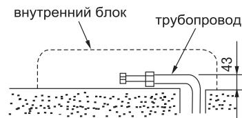
3. Пропустите дренажный шланг и трубы для хладагента через отверстие в стене с небольшим запасом, далее подвесьте комнатный блок на крюки монтажной пластины.
