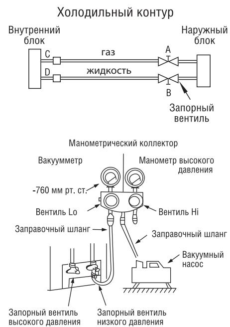
После завершения откачки полностью закройте вентиль Lo и выключите вакуумный насос. Произведите проверку показаний манометра, стрелка не должна отклоняться от значения достигнутого после остановки вакуумного насоса. Повышение давления свидетельствует о наличии негерметичности в системе. В данном случае необходимо найти и устранить негерметичность в системе и повторить процесс вакуумирования.
