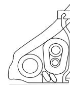
6. Откройте лицевую панель, далее снимите сервисную крышку и пропустите провода межблочных соединений от наружного блока через отверстие в задней части корпуса внутреннего блока. Выведите их с лицевой стороны.
