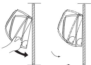
6) Надавите на нижнюю часть корпуса внутреннего блока обеими руками для закрепления его на крюках монтажной пластины. Следите за тем, чтобы по краям комнатного блока не было защемлений проводов.
