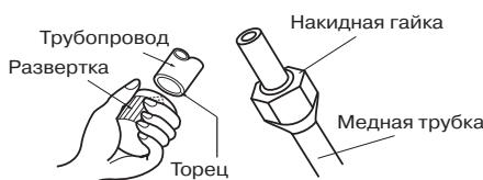
3. Отсоедините накидные гайки, прикрепленные к внутреннему и наружному блокам кондиционера. Затем установите их на трубы, с которых уже удалены заусенцы и надета теплоизоляция.
